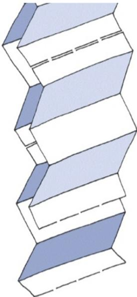
Beim Interfold-Falhtandtucl laufen zwei mehrfach gefaltete Bahnen parallel. Die einzelnen Falhtandtücher sind durch eine Abrissperforation verbunden, diese reißt beim Herausziehen des Tuches, und das unterste Falhtandtuch der anderen Bahn schaut nun unten aus dem Spender. Die Falhtandtücher sind nach dem Entnehmen vollständig entfaltet.
